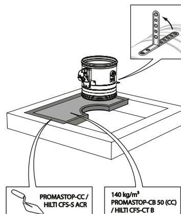
1. Le colmatage s'effectue au moyen de 2 couches de panneaux de laine minérale d'épaisseur 50 mm recouverte d'enduit coupe-feu sur une face (type PROMASTOP-CB 50 / PROMASTOP-CB/CC 50 / HILTI CFS-CT B).
