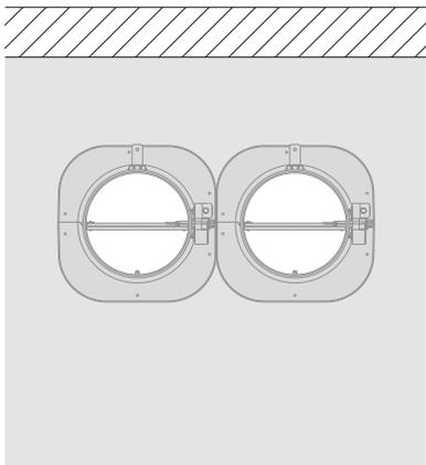
5. Les clapets peuvent être installés à distance minimale d'une paroi ou d'un autre clapet.
