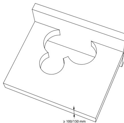
4. Prévoyez dans la dalle les réservations nécessaires ( $\leq Dn + 80$  mm).
