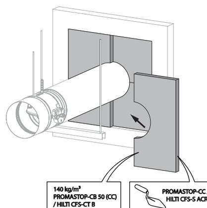
3. Une réservation de dimensions maximales « A » est réalisée au travers de la paroi.
