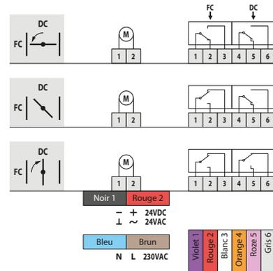
DC : Contact position ouverte du clapet
