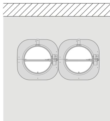
6. Les clapets peuvent être installés à distance minimale d'une paroi ou d'un autre clapet.
