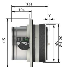
Dépassement de la lame : 20 mm pour ØDn 315 mm
