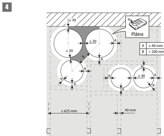
4. Les clapets peuvent être installés à distance minimale ( $\geq 30\text{ mm}$ ) d'une paroi ou d'un autre clapet.
