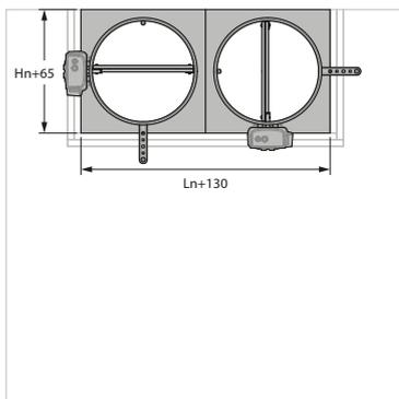
9. Les clapets coupe-feu peuvent être installés à distance minimale d'un autre clapet, d'une dalle/d'un plafond.
