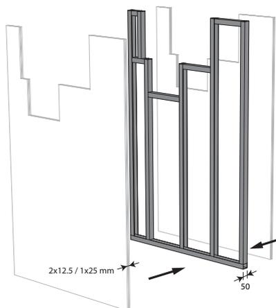
5. Assemblez la paroi légère en prévoyant les chevêtres horizontaux et verticaux nécessaires pour la réservation. Dans le cas d'une ouverture de mur circulaire, l'espace entre les plaques de plâtre est partiellement (jusqu'à  $D_n + 40$  mm) rempli de laine de roche d'une densité minimale de  $40\text{kg/m}^3$ .
