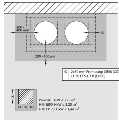
8. Les clapets peuvent être installés à distance minimale d'une paroi/dalle ou d'un autre clapet.
