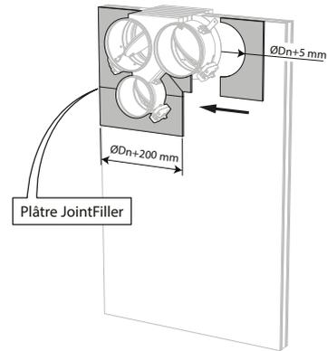
8. Finissez la surface des 2 côtés avec des talons de plâtre. Rejointoyez les espaces entre les talons et entre talons et plaques à l'aide de jointfiller.
