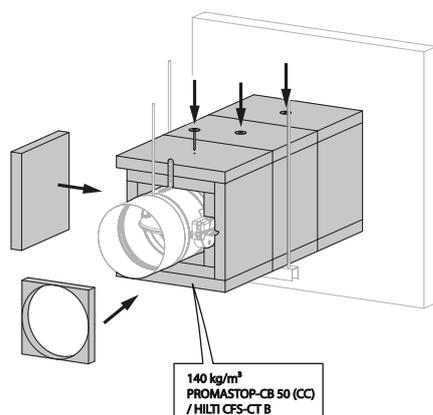
5. La gaine traversante est recouverte de panneaux de laine de roche « G » revêtus sur une face d'enduit coupe-feu pour adhérer à la gaine et fixés à la gaine par vis et rondelles « E ». Le corps du clapet est également ainsi protégé sur une longueur de 171 mm. Une réservation est opérée dans le panneau de laine de roche à hauteur du mécanisme afin de garantir l'accès à celui-ci.
