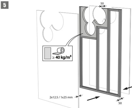
5. Assemblez la paroi légère en prévoyant les chevêtres horizontaux et verticaux nécessaires pour la réservation. Lors du montage d'un seul clapet coupe-feu à distance minimale du plafond, il n'est pas nécessaire, du point de vue de la protection incendie, de prévoir un chevêtre autour de la réservation.
