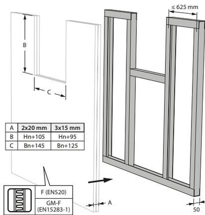
5. Le clapet coupe-feu peut être installé à une distance minimale du plafond/de la dalle.
