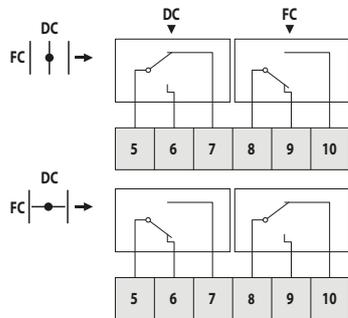
DC : Contact position ouverte du clapet
