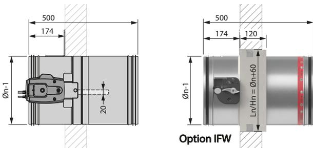
Dépassement de la lame : 20 mm pour ØDn 315 mm
