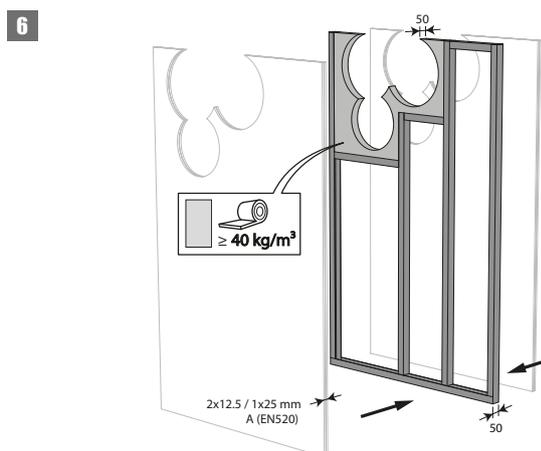
6. Assemblez la paroi légère en prévoyant les chevêtres horizontaux et verticaux nécessaires pour la réservation. Dans la réservation autour des clapets ( $Dn + 50$  mm), le vide entre les plaques de plâtre cartonné est rempli de laine de roche d'une densité minimale de 40 kg/m<sup>3</sup>.
