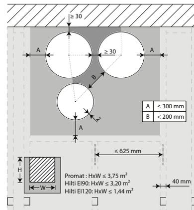
8. Les clapets peuvent être installés à distance minimale ( $\geq 30$  mm) d'une paroi ou d'un autre clapet.
