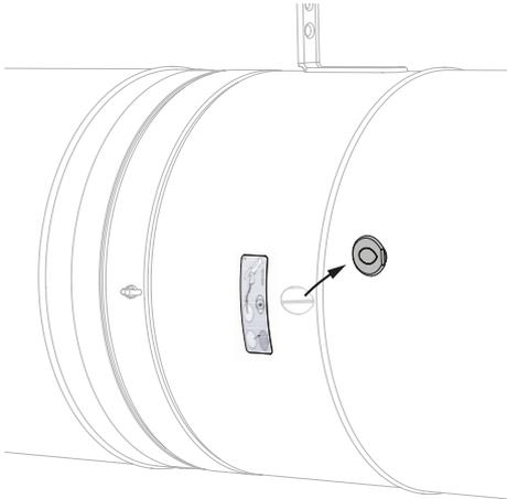
1. Une ouverture d'inspection (uniquement disponible en cas de commande de l'option 'UL') permet de déterminer visuellement la position et l'état du clapet à l'aide d'un endoscope. Pour les clapets coupe-feu équipés du mécanisme ONE, il est également possible d'effectuer cette inspection par caméra à travers l'ouverture du fusible thermique.
