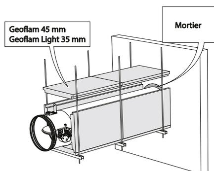
5. La réservation autour de la gaine dans la paroi est remplie par du mortier standard. La gaine traversante est recouverte de plaques de staff de référence GEOFLAM F d'épaisseur 45 mm ou GEOFLAM Light d'épaisseur 35 mm « G ». Les plaques sont fixées entre elles autour de la gaine par colle et polochonnage « E ». Le corps du clapet est également ainsi protégé sur une longueur de 171 mm.
