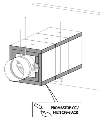
6. Les jonctions entre panneaux, entre panneaux et paroi, ainsi que les vis et les rondelles sont enduits par un coating de type PROMASTOP-CC / HILTI CFS-S ACR.
