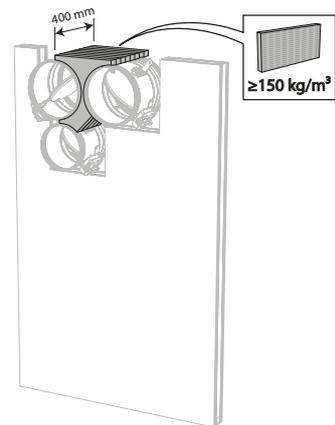
6. Installez et fixez les clapets dans la réservation. Colmatez la réservation du côté des distances minimales à l'aide de panneaux rigides de laine de roche ( $\geq 150\text{kg/m}^3$ ) sur une profondeur de 400 mm (150 mm du côté mécanique de la paroi). La surface de ce colmatage est fixée entre les axes (centres) des clapets.
