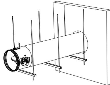
3. Une réservation de dimensions maximales « A » est réalisée au travers de la paroi.
