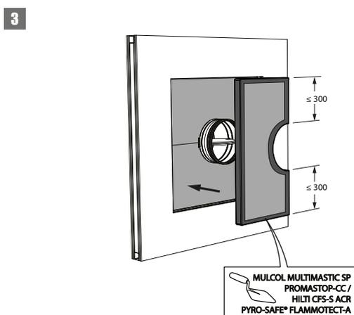
3. Les 2 couches sont posées à joints décalés et ces joints sont recouverts sur tout le contour du panneau d'enduit de type PROMASTOP-CC / HILTI CFS-S-ACR / Mulcol Multimastic SP / PYRO-SAFE® FLAMMOTECT-A.
