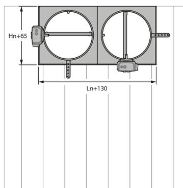
8. Les clapets coupe-feu peuvent être installés à distance minimale d'un autre clapet, d'une dalle/d'un plafond.
