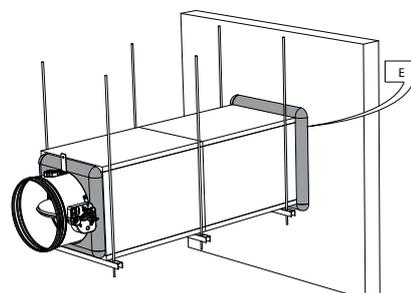
6. La protection en staff GEOFLAM F / GEOFLAM Light s'arrête à 20 mm du mur. L'espace libre entre le mur et la protection en staff est comblé par bourrage de polochons (mélange de plâtre et de filasse). Ce bourrage est également appliqué sur la jonction entre le conduit et le tunnel du clapet.
