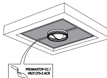
3. Les 2 couches sont posées à joints décalés et ces joints sont recouverts sur tout le contour du panneau d'enduit de type PROMASTOP-CC / HILTI CFS-S-ACR.
