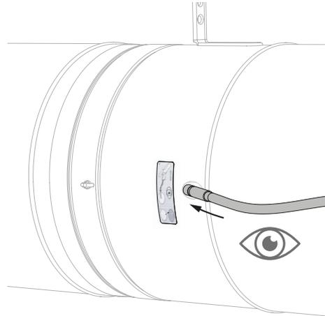
2. Introduisez la caméra de l'endoscope (par exemple Inspecam Rf-t) dans l'ouverture et inspectez l'intérieur du clapet.
