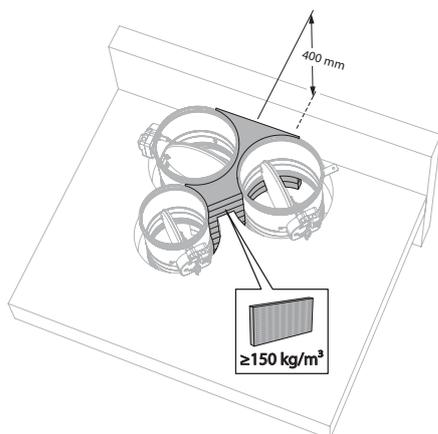
5. Installez et fixez les clapets dans la réservation.
