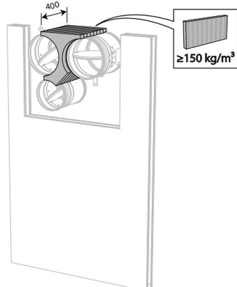
11. Colmatez la réservation du côté des distances minimales à l'aide de panneaux rigides de laine de roche ( $\geq 150 \text{ kg/m}^3$ ) sur une profondeur de 400 mm (150 mm du côté mécanique de la paroi).
