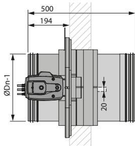
Dépassement de la lame : 20 mm pour ØDn 315 mm
