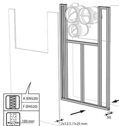
10. Assemblez la paroi légère en prévoyant les chevêtres horizontaux et verticaux nécessaires pour la réservation. Lors du montage d'un seul clapet coupe-feu à distance minimale du plafond, il n'est pas nécessaire, du point de vue de protection incendie, de prévoir un chevêtre autour du clapet coupe-feu en cas de résistance au feu EI60S/EI90S souhaitée. Installez et fixez les clapets dans la réservation.
