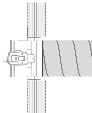
4. Avec une épaisseur de paroi ≥ 135mm (≥ 290mm pour CR120-L500), le conduit de raccordement tombe dans la paroi.
