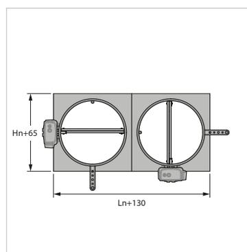
4. Les clapets coupe-feu peuvent être installés à distance minimale d'un autre clapet, d'une dalle/d'un plafond.
