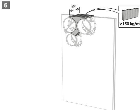
6. Installez et fixez les clapets dans la réservation. Colmatez la réservation du côté des distances minimales à l'aide de panneaux rigides de laine de roche ( $\geq 150 \text{ kg/m}^3$ ) sur une profondeur de 400 mm (150 mm du côté mécanique de la paroi).
