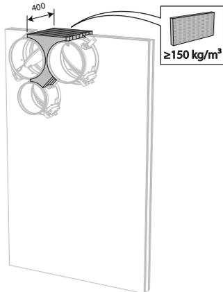
7. Installez et fixez les clapets dans la réservation.
