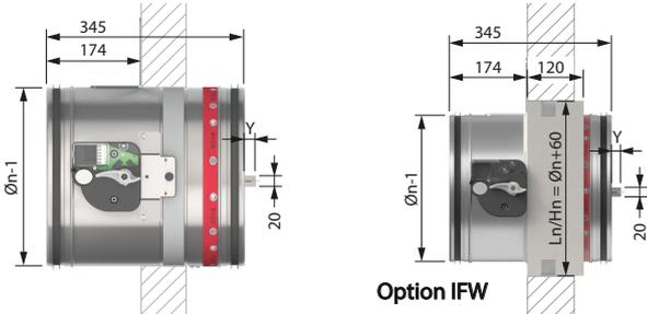
Dépassement de la lame : 20 mm pour ØDn 315 mm
