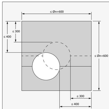
7. Le clapet peut mais ne doit pas être centré dans la réservation (de dimensions maximales clapet + 600 mm). Une distance maximale de 400 mm doit être respectée par rapport au bord de la réservation.
