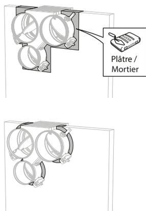
7. Colmatez le reste de la réservation à l'aide de mortier ou de plâtre standard.
