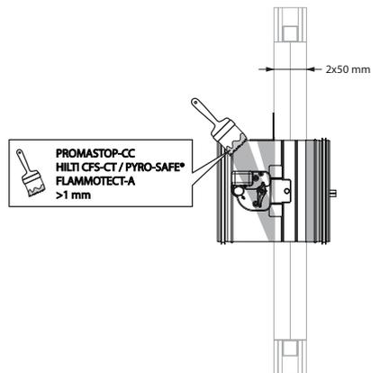
5. Pour EI 120 S, le tunnel du clapet doit être recouvert d'une couche (> 1 mm) d'enduit (type PROMASTOP-CC / HILTI CFS-CT / PYRO-SAFE® FLAMMOTECT-A).
