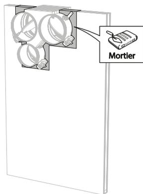
7. Colmatez le reste de la réservation à l'aide de mortier standard sur l'épaisseur totale de la paroi.
