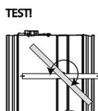
7. Les clapets peuvent être installés à distance minimale d'une paroi/dalle ou d'un autre clapet.
